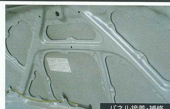
パネル接着・補修
